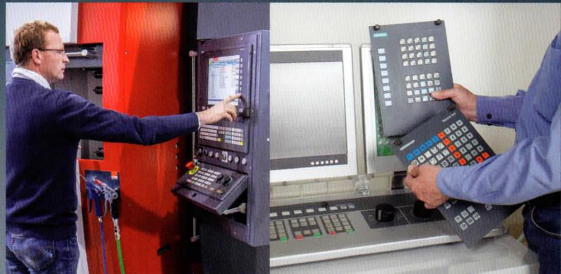
Formación orientada a la práctica de usuarios en todos los controles industriales CNC habituales en una sola máquina. El cambio a un control distinto se hace ejecutando el Software requerido y cambiar simplemente el módulo específico de control en solo un minuto.
